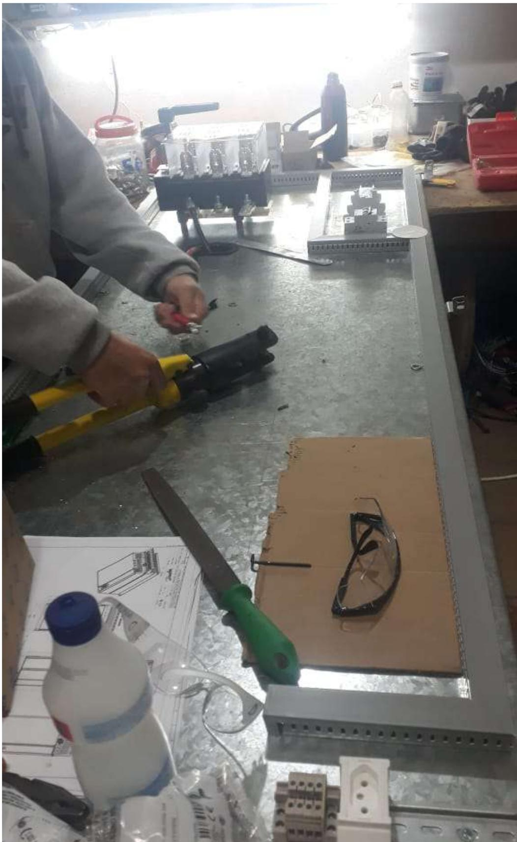
Foto 20 – Montagem da parte interna dos quadros.
