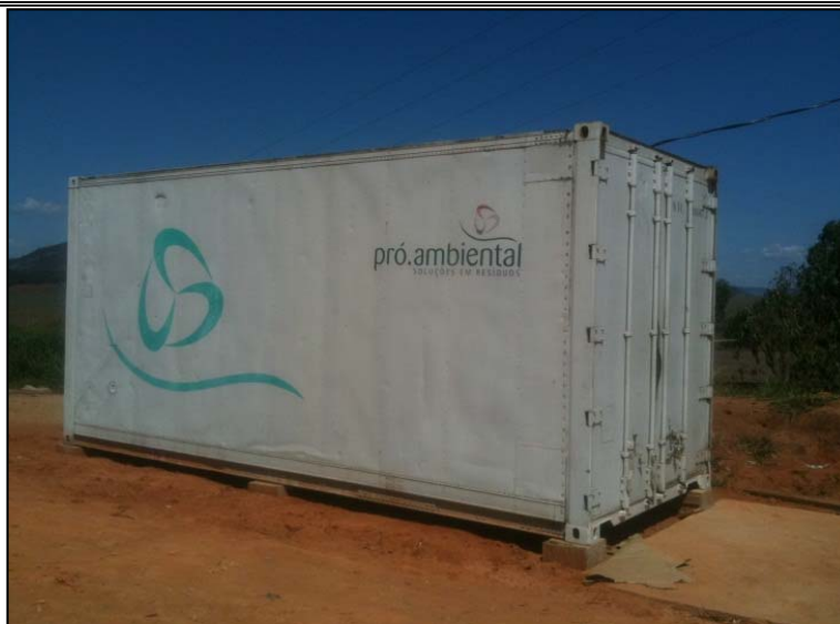
Figura 1.15. Câmara fria para acondicionamento dos resíduos da saúde.
