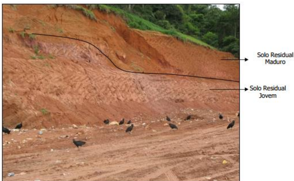
Figura 4.3 – Perfil litológico do solo local
