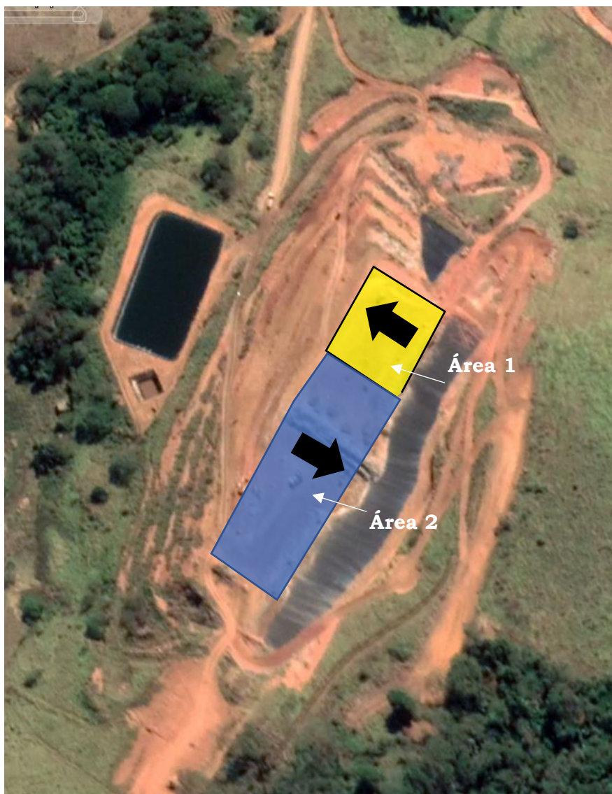
Figura 7.3- Caimentos atuais no platô superior do aterro
